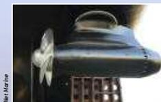
\*Le pod est un propulseur en nacelle suspendue installé sous la coque qui remplace le couple hélice-gouvernail. Il peut être orienté sur 360°, ce qui rend ce type de navire très maniable.
