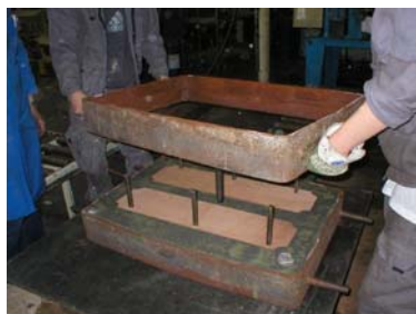
Mise en place du cadre de la partie supérieure.
